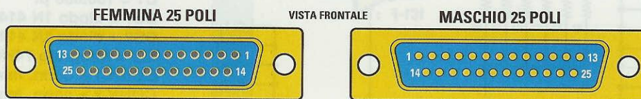
Fig.6 Guardando frontalmente il connettore Femmina, a sinistra è visibile il terminale 13 e a destra il terminale 1. Guardando frontalmente il connettore Maschio, a sinistra è visibile il terminale 1 e a destra il terminale 13.
