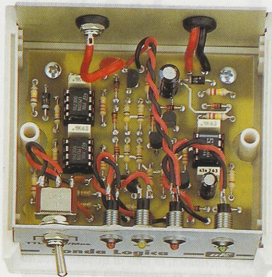
Fig.10 Il circuito stampato va fissato con 3 viti autofilettanti all'interno del mobile plastico, che forniamo completo di mascherina forata e serigrafata (vedi fig.1).
