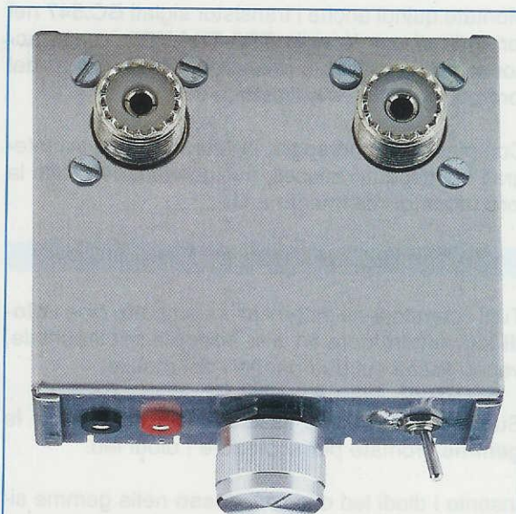
Fig.2 Scatola del rosmetro vista dal lato da cui fuoriescono i due bocchettoni RF.
